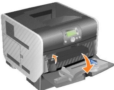
3. 封筒フィーダのタブとプリンタの両側にあるスロットの位置を合わせて、カチッと入るまで封筒フィーダを慎重にスロットにはめ込みます。
