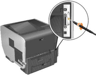
9. 接合部を壊さないように注意して、アンテナの向きを調整します。
