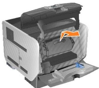
**⚠ 警告:** トナーカートリッジの交換の際には、新しいカートリッジを長時間直接光にさらさないようにしてください。長時間の露光は印刷品質の劣化の原因になります。
