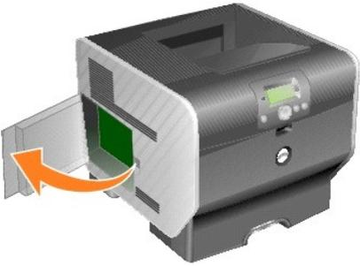
⚠ **注意：** オプションカードは静電気を受けると壊れやすい構造をしています。オプションカードに触れる前にプリンタの枠などの金属に触れるようにしてください。
